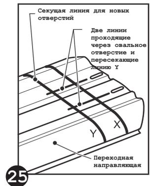
**д** Если для вашего бассейна требуется дополнительная крепежка, просверлите дополнительное отверстие размером 6 мм (1/4"), 38 мм (1-1/2") или 54 мм (2-1/8") на линии **Y**. Примените эту дистанцию на вашем бассейне.
